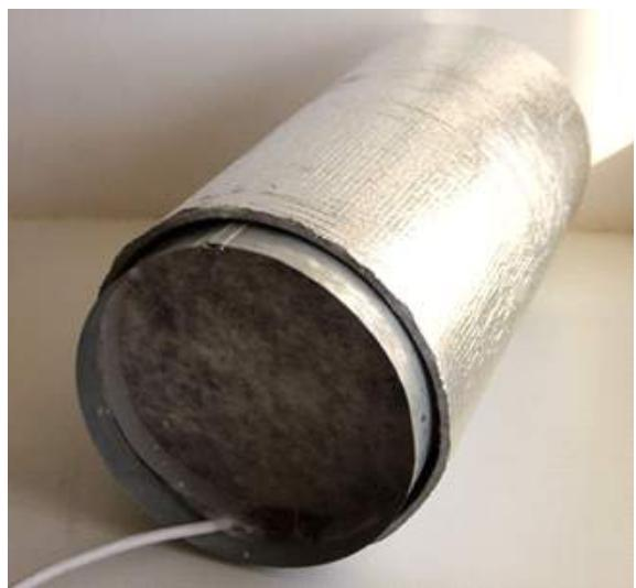
На внешнюю часть телескопического корпуса наклеена самоклеющаяся теплоизоляция из вспененного полиэтилена такой толщины, чтобы корпус плотно входил в отверстие в стене.
