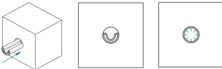
Рис. 6. Установка теплоизоляции в канал трубы.
